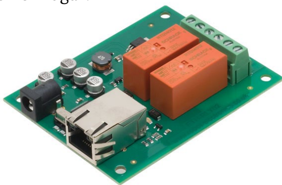
Placa de desarrollo para la automatización del hogar con dos transmisores para apagar y encender la red eléctrica
